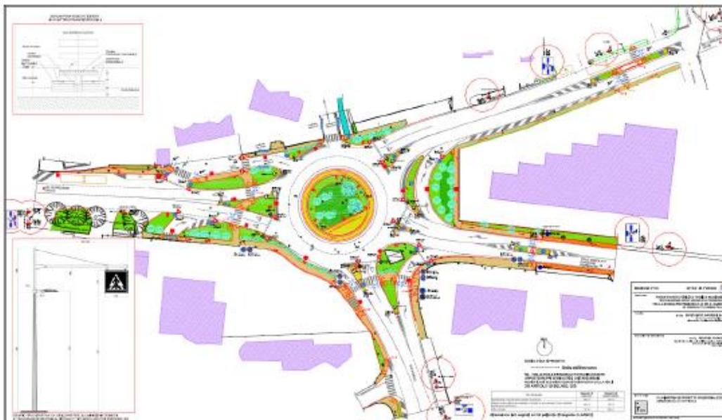
Affidarsi ad un anello circolatorio di 50 m di diametro garantisce un alto livello di servizio oltre ad abbassare le velocità in approccio ed in uscita dall'incrocio a sicuro vantaggio della sicurezza.
